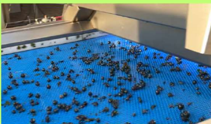
Optischen Sortiermaschine im Weingut mit Merlot Trauben
