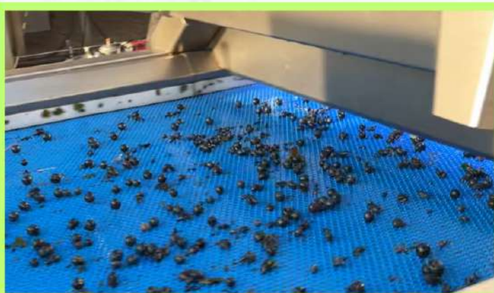
Selezionatore ottico in azione con uve Merlot
